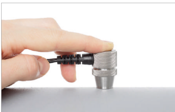
Czujnik grubości ścianki NT z KATflow 230 w czasie pracy
