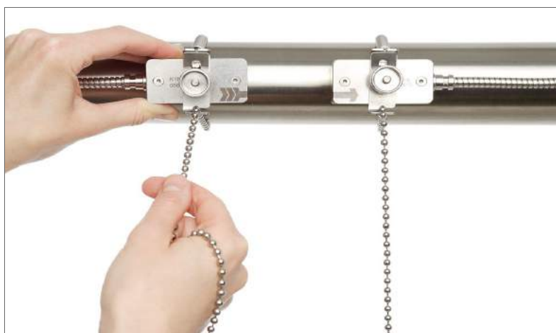
Rys. 10: Montaż sond za pomocą klamry i łańcuchów
