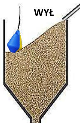
Po osiągnięciu wysokiego poziomu, sygnalizator przechyla się i zatrzymuje napełnianie silosu
